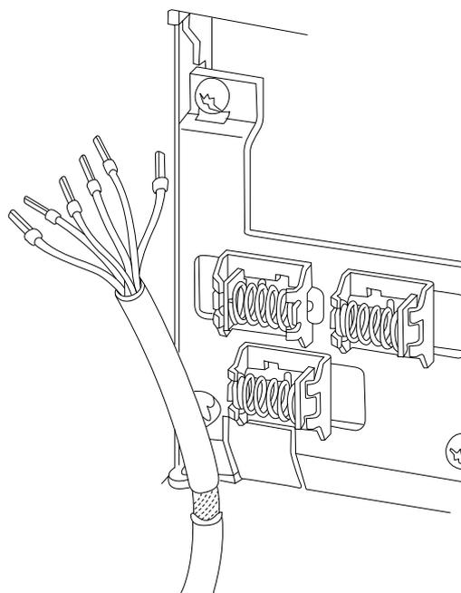
图 1.5 将屏蔽/铠装控制电缆接地
