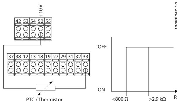
图 4.5 PTC 热敏电阻连接 - 数字输入
