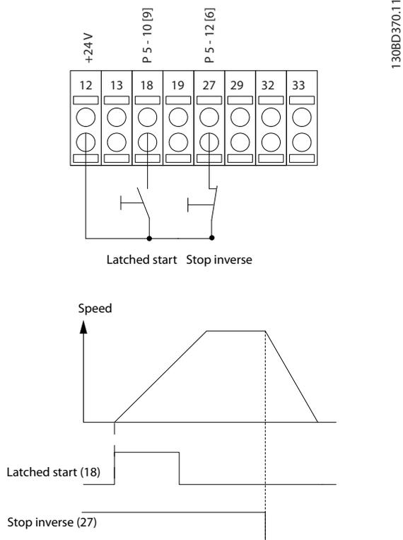
图 1.7 自锁启动/停止反逻辑
