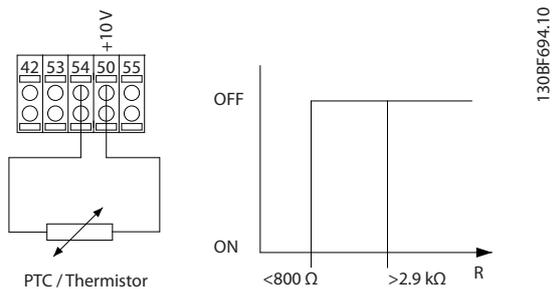
图 4.6 PTC 热敏电阻连接 - 模拟输入
