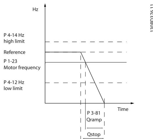
图 4.12 快速停止减速时间
